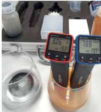
1b – Wasserprobe trüb, mit pH 8,06 und el. Leitfähigkeit 788 µS/cm nicht o. k.
