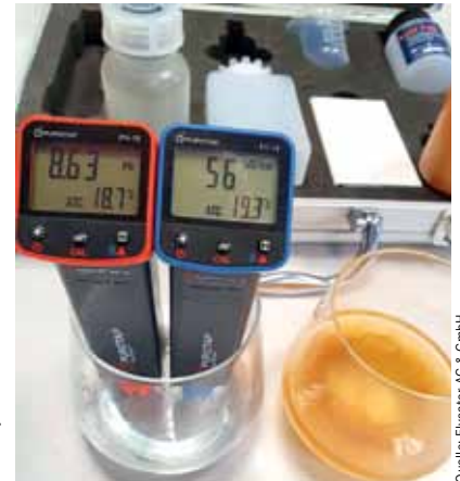
1c – Wasserprobe klar, mit pH 8,63 und el. Leitfähigkeit 56 µS/cm o. k.
