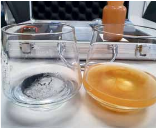
1a – Vergleich von Wasserproben: linke Probe nahezu makellos mit leichtem Magnetit, die rechte deutet auf einen ablaufenden Korrosionsprozess hin.
