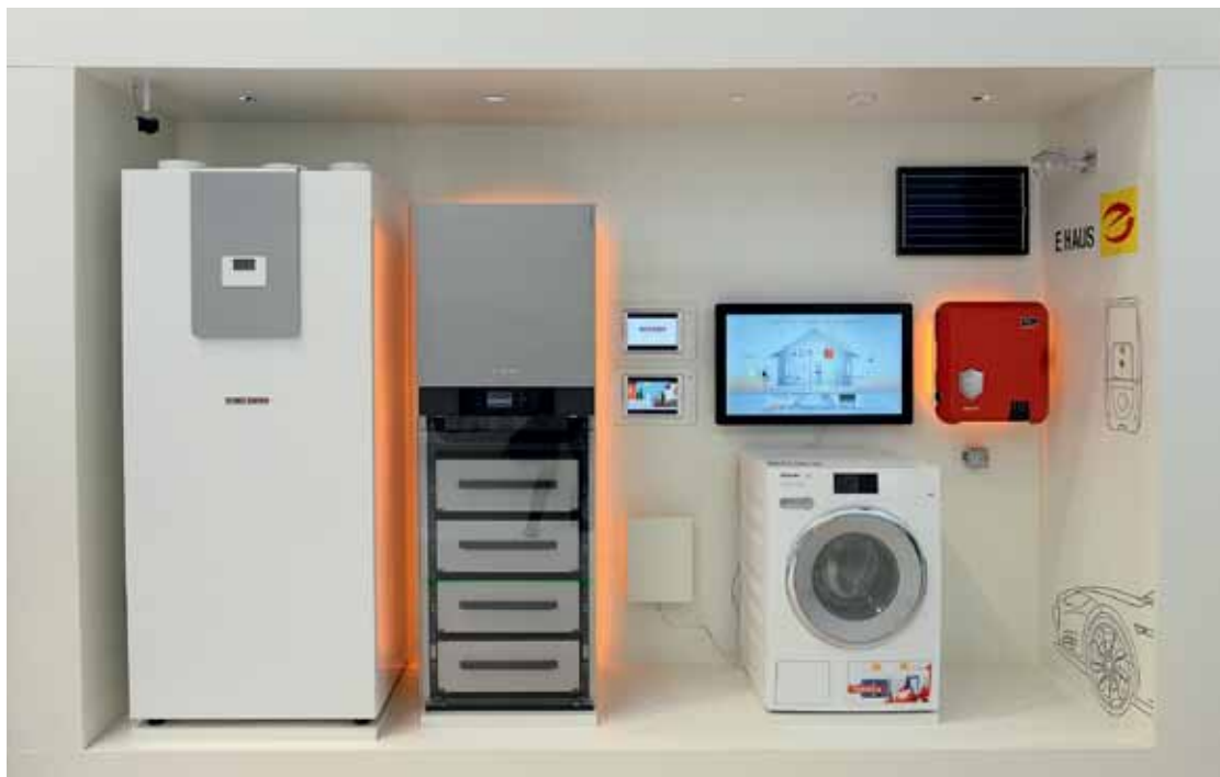
Die Wärmepumpe, der elektrische Speicher, die Waschmaschine und der Wechselrichter der PV-Anlage (v. l.) werden über ein Energiemanagementsystem gesteuert. Die Waschmaschine, Wärmepumpe oder Ladung des Elektrofahrzeuges werden bei genügend Sonneneinstrahlung oder Batteriekapazität betrieben.
