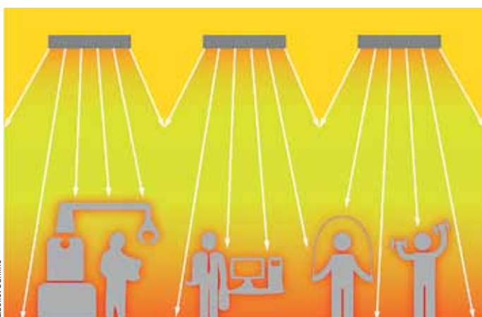
Funktionsprinzip von Deckenstrahlplatten
